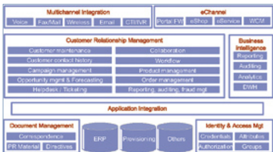
Figura 1 Diagrama de integração do CRM com outros sistemas de TI.
